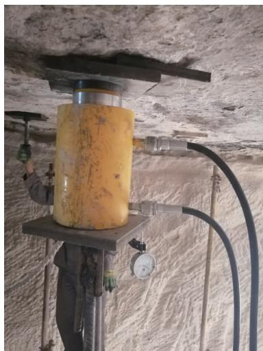
图 8 玻璃纤维锚杆拉拔试验
