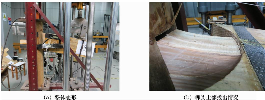
图6 试件JSF破坏形态
