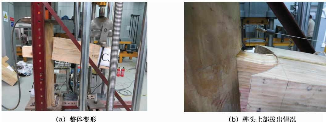
图3 试件 CJ 破坏形态
