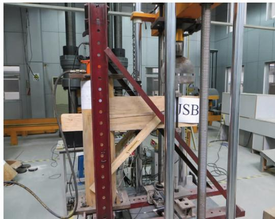
图2 试验加载装置
