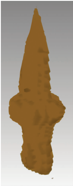
图 11 转轴的 CT 渲染图
